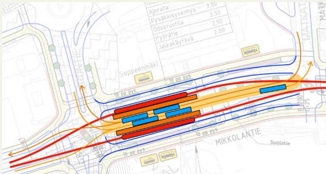
VE2A Vaihtoterminaali kadun keskellä
